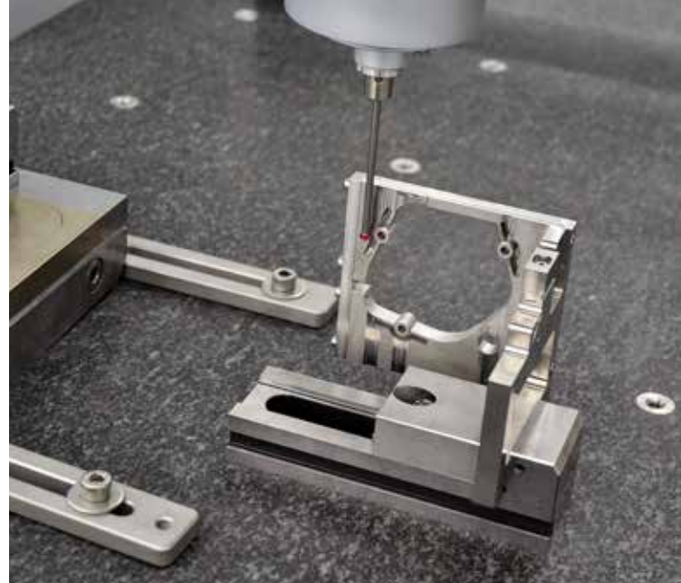
Hochgenaues Messen einer Komponente für ein Lithographie-System.
